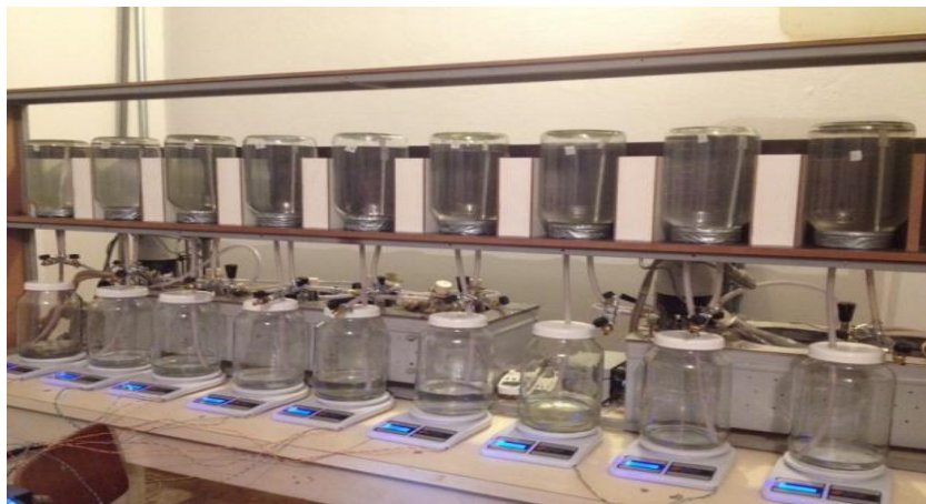
Figura 6: Bancadas de reatores utilizados nos experimentos de biodigestão anaeróbia.
