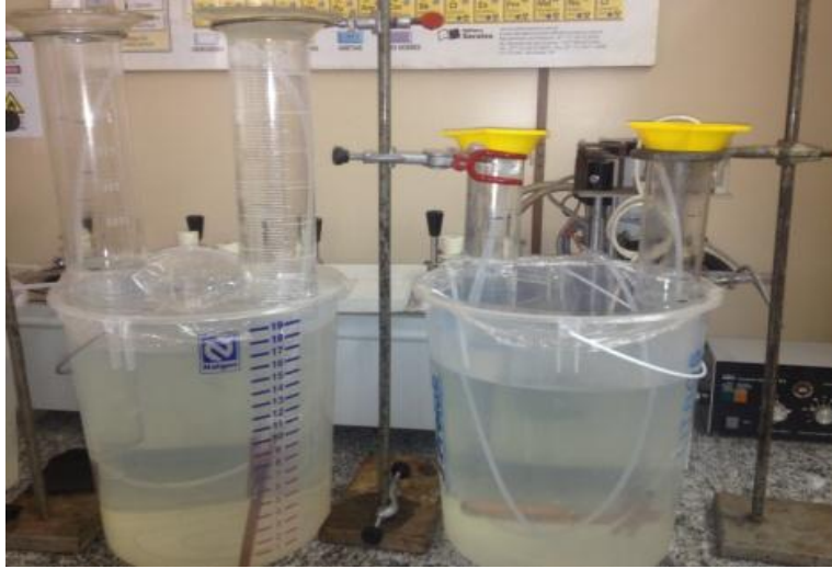
Figura 4: Protótipo inicial do funcionamento do reator anaeróbico com o sistema de captação de biogás
